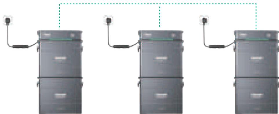
La communication locale ZenLink entre plusieurs ensembles garantit la sécurité, l'efficacité et la simplicité. (Chaque phase a une sortie maximale de 1 800W.) Plusieurs systèmes Hyper peuvent être installés sur 3 phases, chacune ayant une capacité maximale de 23,04 kWh, ce qui permet d'exploiter jusqu'à 69,12 kWh de stockage d'énergie.
